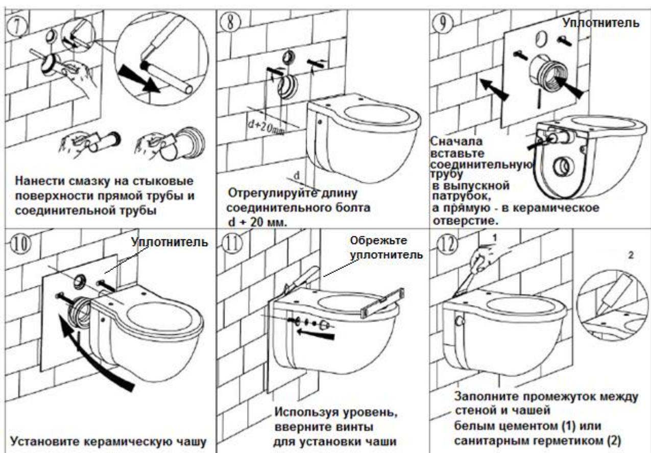
10Б. Стандартная установка унитаза скрытого монтажа (рис.11 -1 – 11-5).
