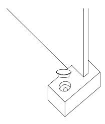
5. Пройдите силиконовым герметиком низ стекла, а также внутреннюю и внешнюю части пристенного профиля. При помощи очистителя для стекол, удалите излишки силиконового герметика, пока он не застыл. Не рекомендуется использование перегородки в течении 24 часов, после нанесения герметика.
