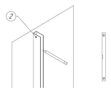
2. Вставьте стекло с профилем (1) в установленный пристенный профиль (2). Отрегулируйте ширину перегородки и закрепите при помощи саморезов (4) используя заглушки(3).
