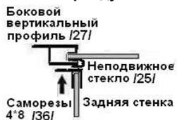
Совместите крепежные отверстия на собранных задних стенках и на каркасе фронтальной стенки, соедините их с помощью саморезов 4\*8 /36/ (рис.12). Установите собранный каркас душевой кабины на поддон /18/. Выровняйте на поддоне каркас душевой кабины по переднему бортику.
