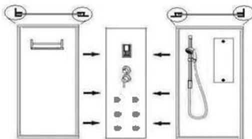
**Внимание!** Не затягивайте винты до упора. Это позволит регулировать их положение в ходе дальнейшей установки. Затяните винты только по окончании полной установки кабины.
