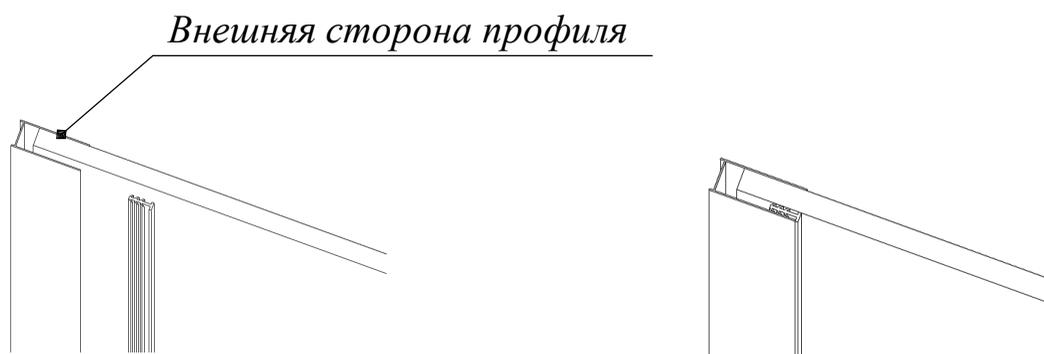
4. Соберите штангу, приложите на стекло и при помощи строительного уровня, обрисуйте на стене элемент крепления штанги. Снимите штангу, сделайте отверстие, уберите мусор. Закрепите элемент крепления штанги. Соберите штангу и затяните все шестигранные винты.
