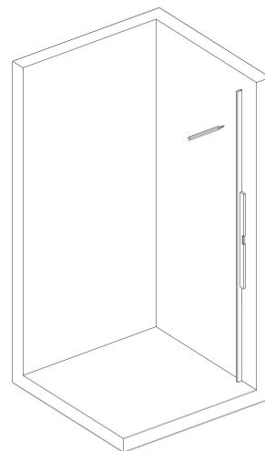
1. *Определите место установки душевой перегородки. С помощью уровня, приложенного к пристенному профилю, отметьте отверстия карандашом на стене. Сделайте отверстия, уберите мусор. Установите пластиковые дюбеля и прикрутите винтами профиль к стене.*
