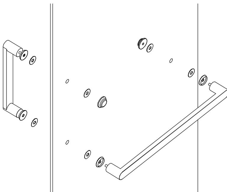
**10.** Отрегулируйте при помощи винтов (14) положение дверцы, после чего затяните винты. Установите заглушки (16) на шляпки винтов (13), заглушки (17) на шляпки винтов петель. Установите все уплотнители душевой кабины.
