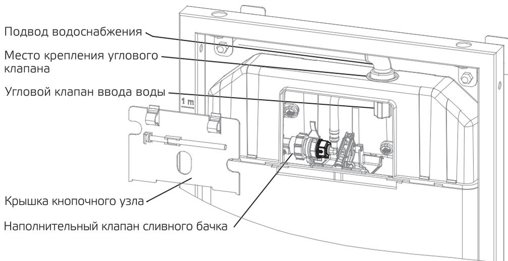
6. После выполнения всех этапов установки инсталляция теперь закреплена к стене и соединена с основной системой водоснабжения и канализации. Чтобы предотвратить проблемы загрязнения во время процесса цементирования или укладки плитки установите на время монтажа: заглушку впускной трубы, заглушку смывной трубы, защиту шпилек и защитный кожух кнопочного узла.
