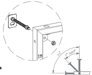
3. Поместите инсталляцию на стену, к которой Вы ее смонтируете. Отметьте стену по корректным точкам крепления к стене и полу. Просверлите отмеченные точки на стене сверлом  $\varnothing 10$  мм. Требуется по крайней мере 70 мм глубиной. Примечание: Проверьте уровнем прямоу установки скрытой системы перед затягиванием гаек.
