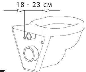
2. Учитывая толщину напольной плитки, определите высоту, на которую вы закрепите унитаз. После этого установите высоту несущих регулируемых ножек рамы. Определите расстояние между стеной и бачком. Затем отрегулируйте и зафиксируйте стенные соединительные части, как показано выше.
