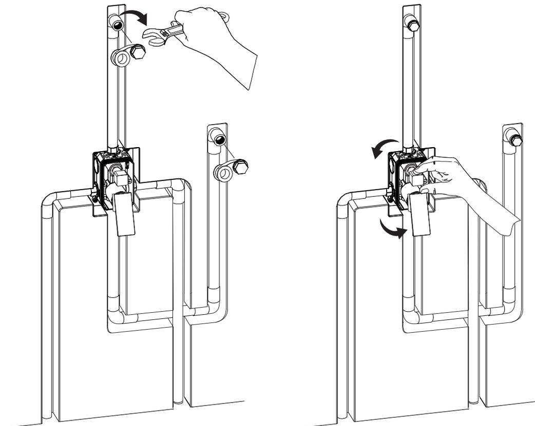
Выполнить проверку герметичности соединений под давлением до 1,6 МПа, не менее 10 минут на каждом режиме работы
