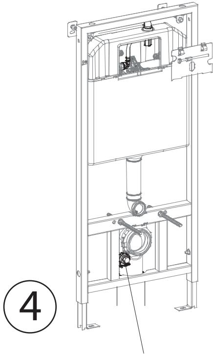
5. Аккуратно удалите крышку кнопочного узла. Соедините гибкую подводку воды с угловым клапаном, надежно соедините узел. Проверьте все соединения углового клапана, чтобы предотвратить утечку и верните крышку кнопочного узла на место.
