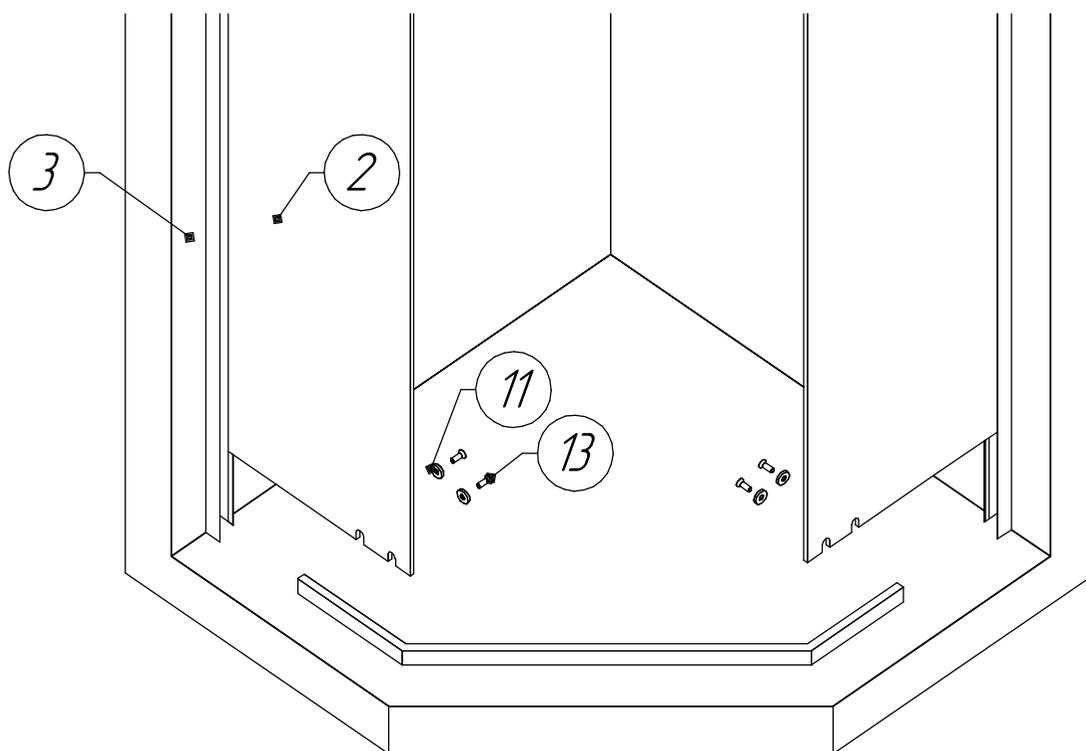
5. Вставьте верхнюю трапецию. Закрепите стекло к трапеции при помощи шайб(11) и винтов(13).
