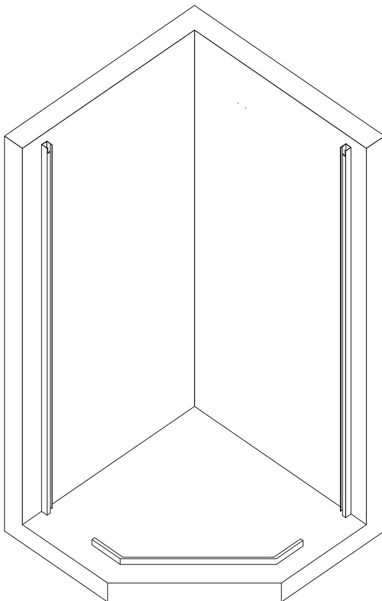
4. Вставьте боковое(2) стекло в паз пристенного профиля(3) и при помощи шайб(11) и винтов(13) закрепите стекло к трапеции(4). Прочелайте аналогичные действия со вторым боковым стеклом.
