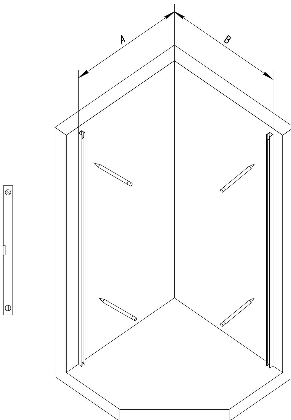
2. Отметьте при помощи рулетки и карандаша расстояние А. При помощи строительного уровня, приложенного к профилю (3), и выставленному по отметке А, сделайте отметку на стене через отверстия в профиле, предназначенные для его крепления к стене. Уберите профиль, сделайте отверстия, уберите мусор. Вставьте в отверстия пластиковые дюбеля(15) и при помощи винтов(12) закрепите профиль к стене.
