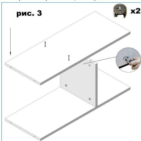
4. Повторите операции из шага 2 и 3 с оставшимися полками (рис.4, рис.5, рис.6, рис.7). Все эксцентрики на полках закройте заглушками.
