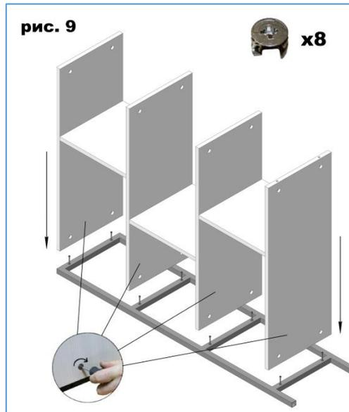
8. Возьмите вторую боковину и соедините её с полками. Вставьте эксцентрики (8шт) в отверстия и при помощи отвертки затяните их по часовой стрелке (рис.10).
