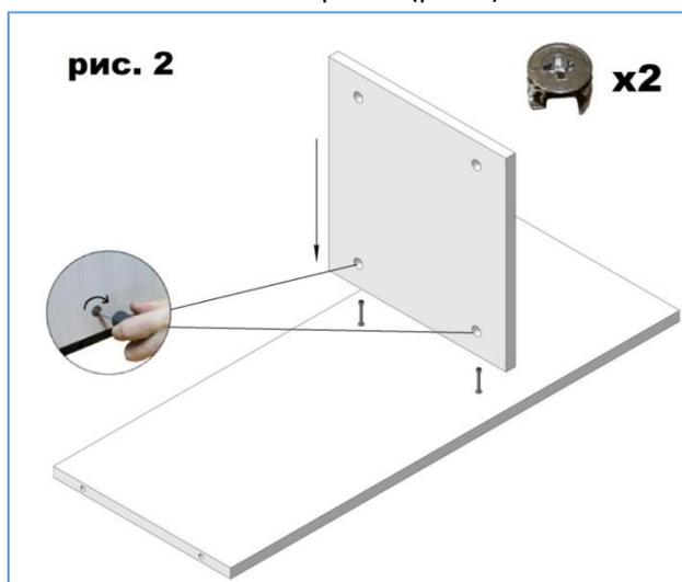
3. Возьмите вторую полку 760\*300 мм и соедините её с полкой 315\*300 мм, установленной ранее. Вставьте эксцентрики (2шт) в отверстия и при помощи отвертки затяните их по часовой стрелке (рис.3).
